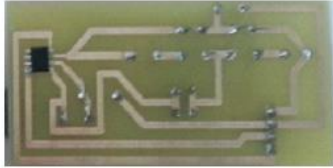
Şekil 10: Notch filtre baskı devresi
